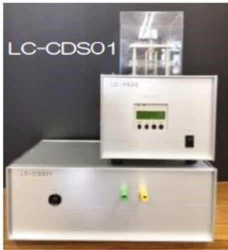
測定機本体+ペルチェ冷却装置(セルホルダー)
